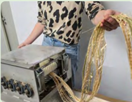
Verarbeitung von Hanffasern in einer Verarbeitungsmaschine.
