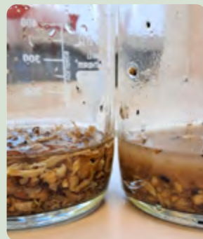
Extraktion von Rübenschnitzeln mit und ohne Enzymzugabe.
